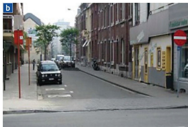
Rys. U.13.2 Przykłady chodnika poprzecznego na wlotach ulic podporządkowanych: a) w Wielkiej Brytanii b) w Belgii Źródło: a) fot. A. Rys, b) SPW Wallonie [97]
