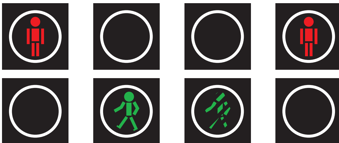
Rys. 7.52 Sygnalizator S-5 dla pieszych z sekwencją nadawanych sygnałów
