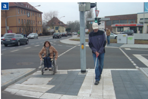
Rys. U.15.2 Przykłady urządzeń (rampy, linie prowadzące) dla osób niepełnosprawnych: a) w Niemczech, b) w Polsce
