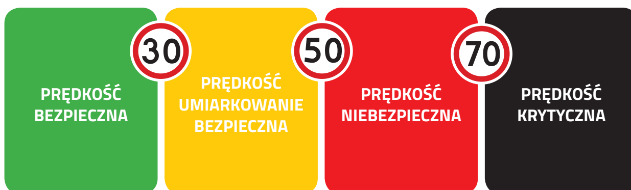
Rys. 3.6 Klasyfikacja prędkości pojazdów ze względu na bezpieczeństwo pieszych
