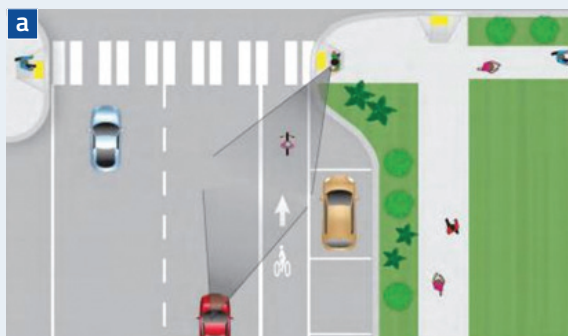
Rys. 7.6 Przykłady wyznaczonego przejścia dla pieszych z zawężeniem jezdni na skrzyżowaniach w USA
