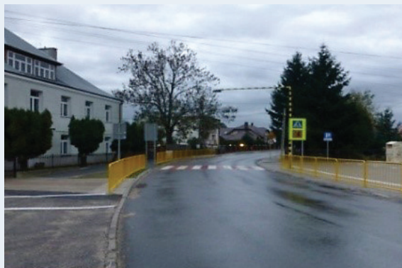
Rys. 6.9 Wygrodzenia i balustrady stosowane w celu powstrzymania pieszych przed wtargnięciem na jezdnię lub upadek ze skarpy
