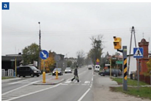
Rys. U.17.2 Przykłady urządzeń do automatycznego nadzoru nad prędkością: a) na drodze krajowej nr 22 w Zblewie, b) na ulicy lokalnej w Gostycynie
