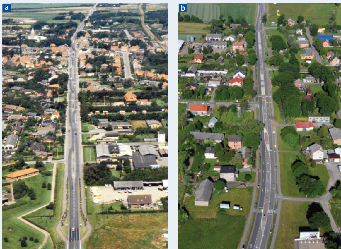
Rys. 5.7 Przykłady przejścia dróg tranzytowych przez miejscowości: a) na drodze tranzytowej w Danii, b) na drodze krajowej nr 7 w miejscowości Koszwały
